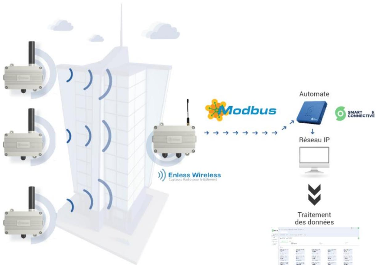
La couverture radio de la passerelle peut varier de quelques centaines de mètres à plusieurs milliers de mètres. Plusieurs facteurs doivent être pris en compte :
